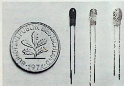
Tantal-Tropfenkondensatoren von NCC Matsuo
