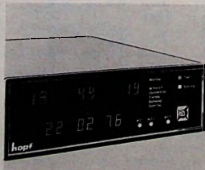
Hopf-Zeitzeichenempfänger mit Digitaluhr, Modell 3300
